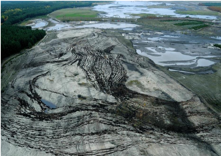
Figure 5 Ground liquefaction at the former Spreetal mine in 2010. Source: Lausitzer und Mitteldeutsche Bergbauverwaltungsgesellschaft (LMBV)
